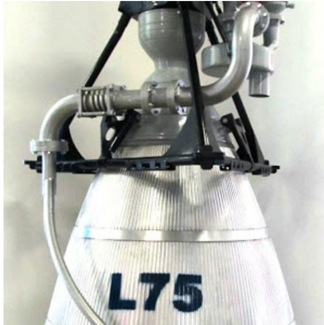
Figura 2.9 – Sistema propulsivo, motor de foguete.
