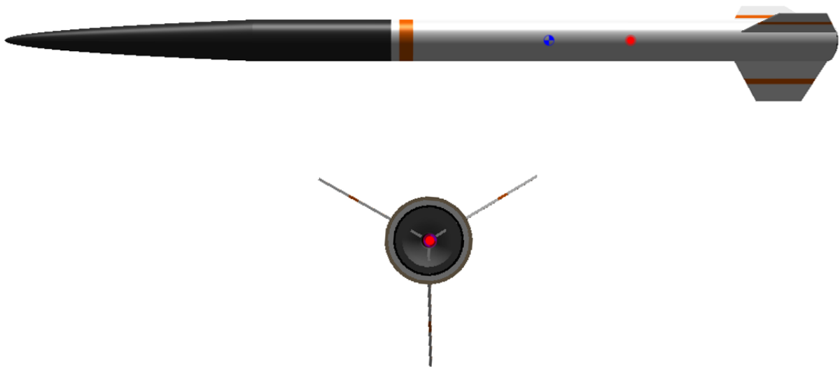
Figura 3.8 – Quantidade e disposição das aletas no corpo do foguete.
